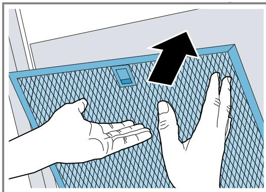
3. S'assurer que les dispositifs de verrouillage s'encliquettent.
