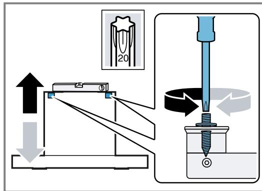
4. Fixer l'appareil par le haut à l'aide de 2 écrous.
