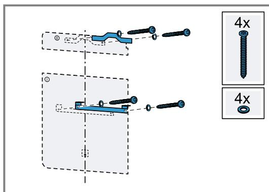
4. Vissez complètement les vis ci-jointes dans la suspension supérieure de l'appareil.
