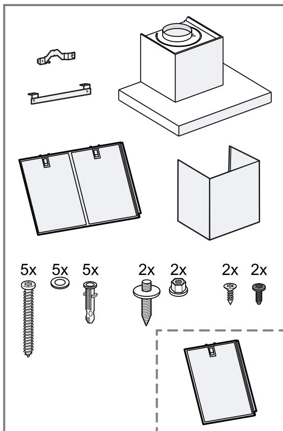
**Remarque :** L'équerre de fixation pour le capot de cheminée ainsi que les petites vis argentées et noires sont comprises dans la livraison, mais ne sont pas nécessaires pour les appareils à air pulsé.
