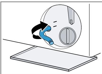
2. Pulire l'interno, la filettatura del coperchio della pompa e il corpo della pompa.
