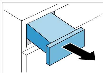
2. Vider le réservoir d'eau de condensation.
