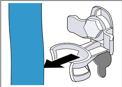
2. Vse vijke 4 transportnih varoval odvijte z vijačnim ključem dim. 13 ① in jih odstranite ②.
