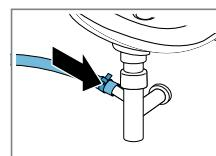
Priključno mesto zavarujte s cevno objemko (24–40 mm).
