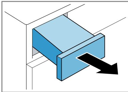
2. Vider le réservoir d'eau de condensation.
