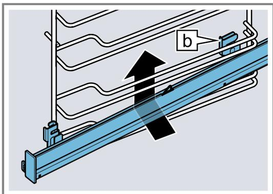
2. Die Schiene längs zu den Führungsstäben nach hinten führen und beide Halterungen jeweils auf den unteren Stab aufschieben. Dabei mit der hinteren Halterung
