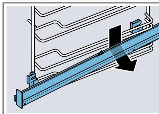
5. Die Auszugsschiene reinigen.
