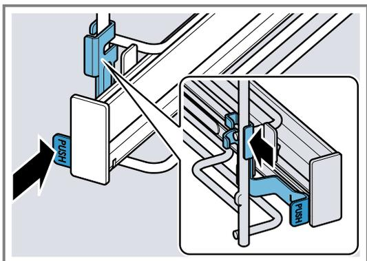
2. **PUSH** gedrückt halten ① und die Schiene nach außen schwenken ②, bis die vordere Halterung a ausgehängt ist.
