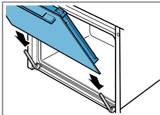
1. Mit beiden Händen die Gerätetür bis zum Anschlag schieben.
