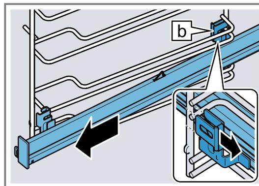
4. Die Auszugsschiene entfernen.
