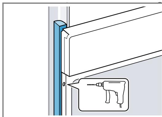
4. Das Gerät mit adäquater Schraube befestigen.
