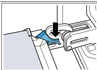
La porte de l'appareil est sécurisée et ne peut pas être décrochée.
