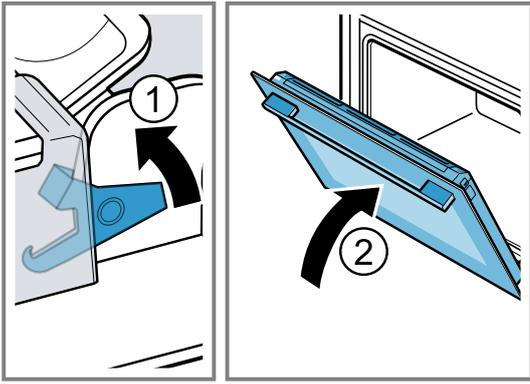
4. Appuyez sur le recouvrement de la porte à gauche et à droite à l'extérieur de la porte de l'appareil ① jusqu'à ce qu'il se débloque.
