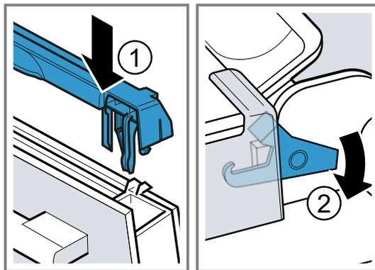
✓ Les leviers de verrouillage sont refermés. La porte de l'appareil est sécurisée et ne peut pas être décrochée.
