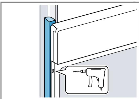
4. Fixez l'appareil avec une vis adéquate.
