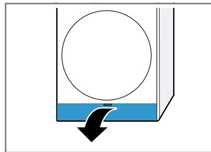
Se si dispone un panno sotto allo sportello di manutenzione, è possibile raccogliere l'acqua residua dell'unità di base.
