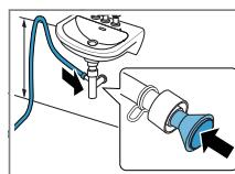
Fissare il punto di collegamento con una fascetta stringitubo (12-22 mm). Fissare il tubo flessibile di scarico dell'acqua con una guida del tubo flessibile a un'altezza minima di 80 cm e massima di 100 cm.
