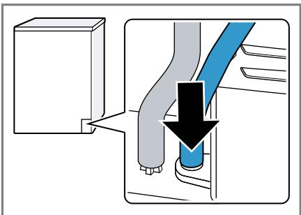
4. Infilare il tubo flessibile di scarico dell'acqua nella guida del tubo flessibile.
