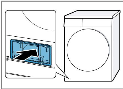
2. Die Hebel der Wärmetauscherabdeckung schließen.
