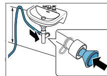
Die Anschlussstelle mit einer Schlauchschelle (12-22 mm) sichern.
