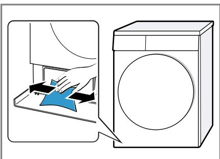
9. Den Einsatz waagerecht bis zum Einrasten der Lasche einschieben.
