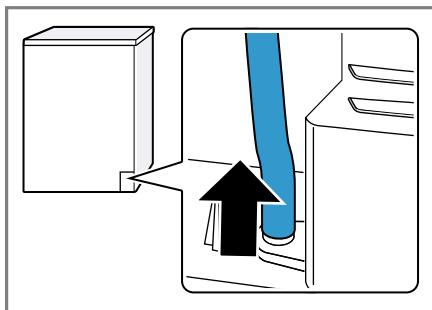
Der Kondenswasserschlauch ist werkseitig am Stutzen angeschlossen.
