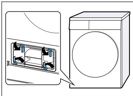
3. Die Wärmetauscherabdeckung am Griff herausziehen.
