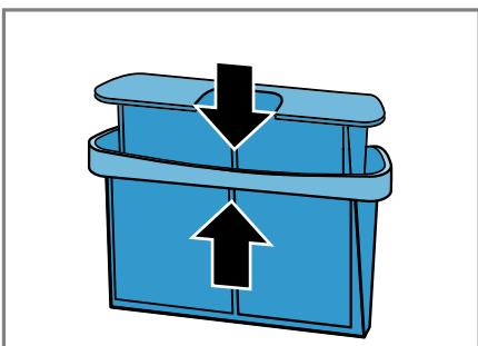
10. Das zweiteilige Flusensieb einsetzen.
