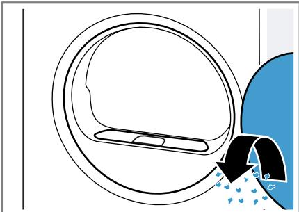
3. Das zweiteilige Flusensieb entfernen.
