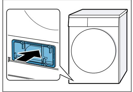
2. Fermez le levier du couvercle de l'échangeur thermique.
