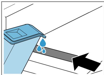
Notez le repère pour remplir le réservoir d'eau à côté de l'ouverture avant.
