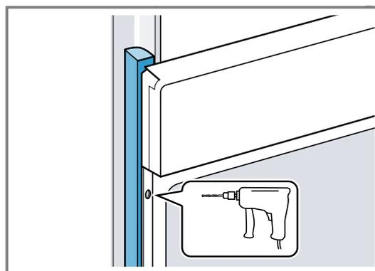
4. Fixez l'appareil avec une vis adéquate.
