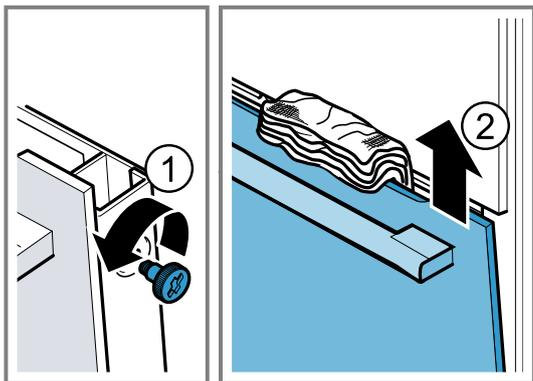
5. Tirer la vitre frontale avec la poignée de la porte vers le bas et la déposer sur une surface plane.
