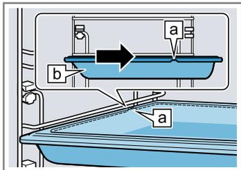
Posez l'accessoire sur les rails télescopiques insérés.
