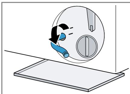
7. **⚠ CUIDADO - Risco de escaldadura!** A água de lavagem fica quente durante a lavagem a elevadas temperaturas.
