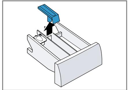
4. Lavar a gaveta para detergente e a peça de doseamento com água e uma escova e secar bem.
