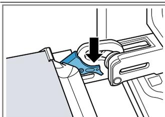
La porte de l'appareil est sécurisée et ne peut pas être décrochée.
