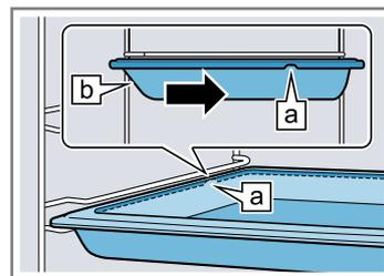
Posez l'accessoire sur les rails télescopiques insérés.
