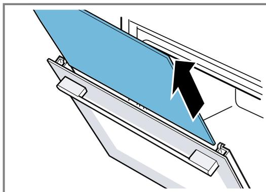
9. Si nécessaire, vous pouvez enlever la baguette de condensation pour le nettoyage.
