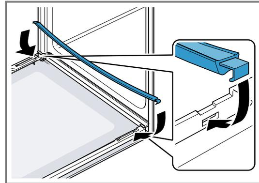
6. Faites glisser la vitre intérieure dans les fixations de gauche et de droite
