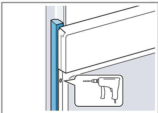
4. Fixez l'appareil avec une vis adéquate.
