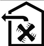
Không khí không được đưa vào ống khói dùng cho khí thải từ các thiết bị đốt khí hoặc nhiên liệu khác (điều này không áp dụng cho các thiết bị khí tái tuần hoàn).
