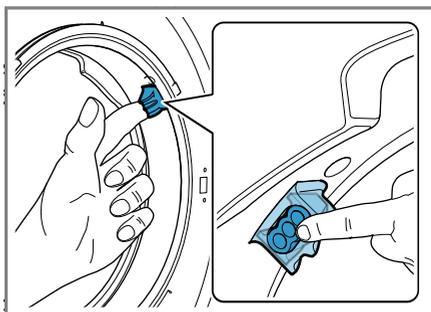
4. Nettoyez le joint en caoutchouc à l'extérieur et à l'intérieur avec un chiffon humide et essuyez-le.
