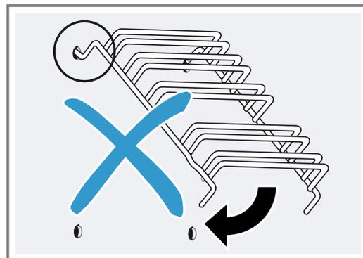
3. Les deux crochets doivent être complètement insérés dans les trous situés dans le haut de la paroi. Déplacez le support vers le bas, lentement et avec précaution, et insérez les crochets inférieurs.
