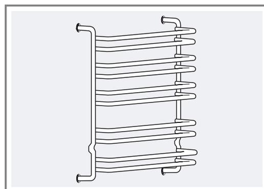
L'installation des supports est réussie lorsque l'écart entre les deux niveaux d'insertion supérieurs est plus important.
