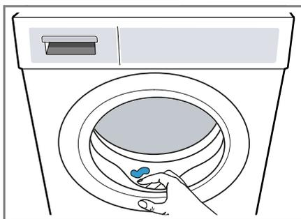
3. Nettoyez le joint en caoutchouc à l'extérieur et à l'intérieur avec un chiffon humide et essuyez-le.
