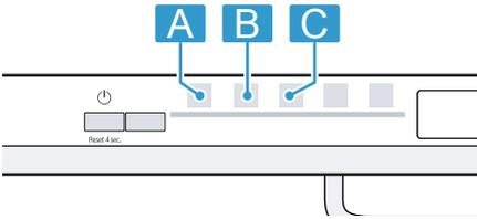
Entsprechend leuchten 0, 1, 2 oder 3 LEDs. Der eingestellte Signalton ist zu hören. Werkseitig ist Stufe 2 eingestellt (LED A und LED B).
