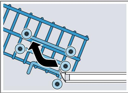
3. Den Geschirrkorb auf den oberen Rollen (Stufe 3) oder unteren Rollen (Stufe 1) einhängen.
