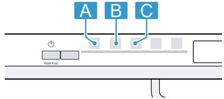
Wenn die LED A leuchtet, ist die Funktion dauerhaft deaktiviert. Wenn die LED A und LED B leuchten, ist die Funktion über die Taste zuwählbar.
