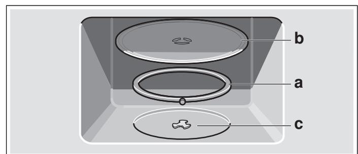
**Remarque :** Utilisez l'appareil uniquement avec le plateau tournant en place. Veillez à ce qu'il soit correctement enclenché et peut tourner librement lorsque l'appareil est en marche.
