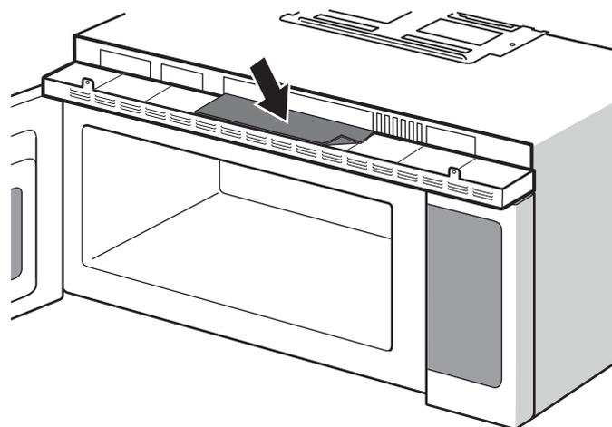
5. Repoussez soigneusement la grille de ventilation en place et remettez en place les vis retirées à l'étape 2.
