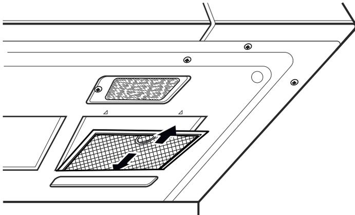
2. Trempez les filtres de ventilation dans de l'eau chaude avec un détergent léger. Rincez bien et sécouez pour sécher. N'utilisez pas de l'ammoniaque et ne lavez pas au lave-vaisselle. L'aluminium du filtre se corrodera et se noircira.
