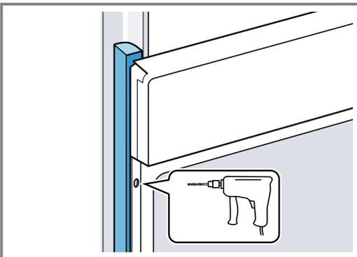
4. Das Gerät mit adäquater Schraube befestigen.
