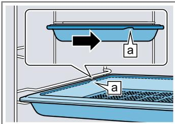
3. Um das Zubehör bei Einschubhöhen mit Auszugsschienen aufzulegen, die Auszugsschienen herausziehen.
