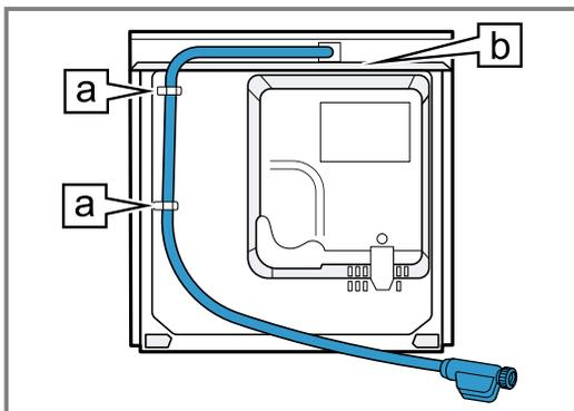
5. Zulaufschlauch mit Anschlusswinkel am Hausanschluss montieren.
