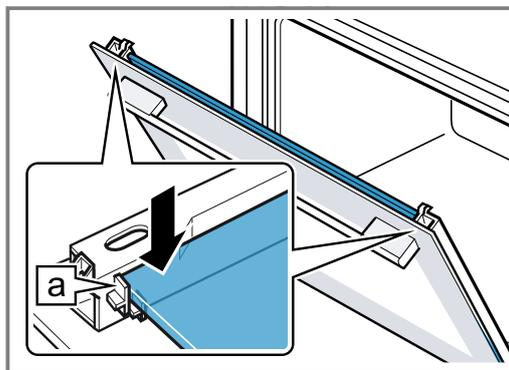
5. Die Gerätetür öffnen und Türdichtung einhängen.
