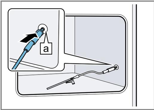
6. Das Röhrchen am Ende des Anschlussschlauches so in den Behälter stellen, dass die komplette Flüssigkeit ins Gerät gepumpt werden kann. Bei Bedarf das Röhrchen mit dem Klipp
