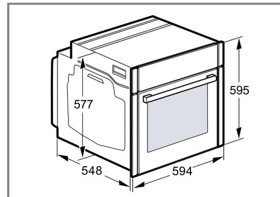
**33.3 Einbau unter einer Arbeitsplatte**
