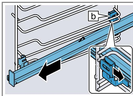
4. Die Auszugsschiene entfernen.
