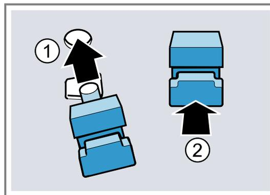
3. Die hinteren Halterungen mit dem Haken in das obere Loch einhängen ① und in das untere Loch eindrücken ②.
