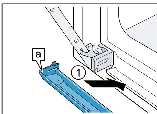
2. Engager les crochets a du bac de condensation à gauche et à droite dans l'espace ①.
