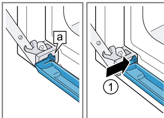
3. Appuyer sur le bac de condensation, jusqu'à ce que les crochets s'engagent à droite, à gauche et en bas.
