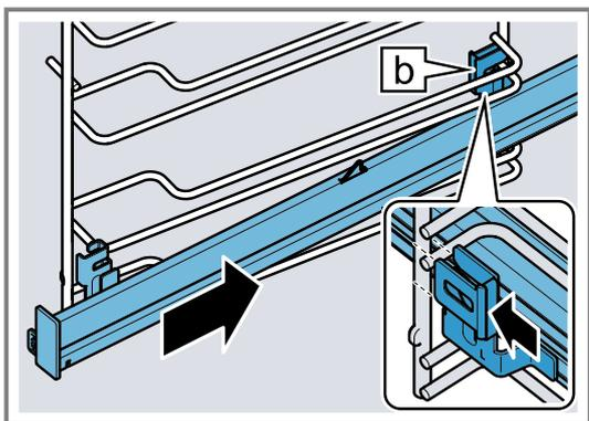
3. Maintenez enfoncé **PUSH** ① et faites pivoter le rail télescopique vers l'intérieur ②, jusqu'à ce que le support
