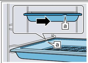
Posez l'accessoire sur les rails télescopiques insérés.
