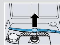
3. Verificați duzele de ieșire ale brațelor de pulverizare sub jet de apă cu privire la înfundări și dacă este cazul, îndepărtați corpurile străine.
