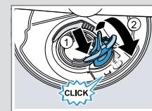
8. Montați sistemul de filtre.
