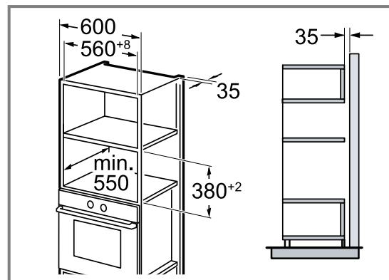
Montați aparatul la o înălțime corespunzătoare, astfel încât să puteți scoate cu ușurință accesoriile.
