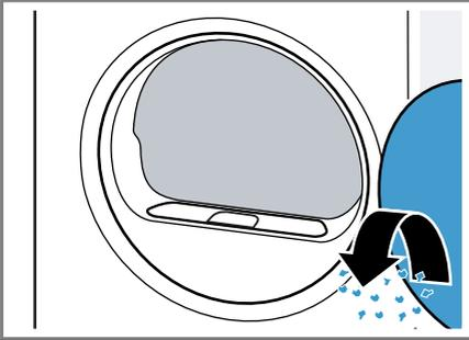
3. Das zweiteilige Flusensieb entfernen.
