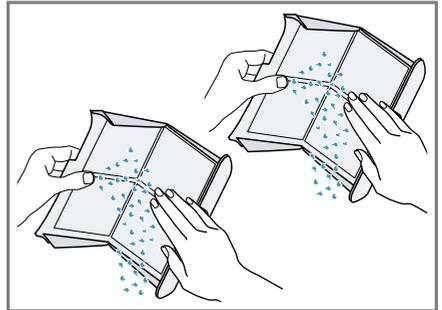
8. Die beiden Flusensiebe gründlich mit fließendem, warmem Wasser reinigen und abtrocknen.
