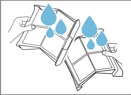
9. Die beiden Flusensiebe schließen und zusammensetzen.
