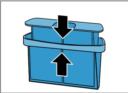
10. Das zweiteilige Flusensieb einsetzen.
