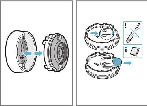
3. Eine neue Batterie einsetzen und dabei die Anweisungen zu den Batteriepolen beachten. Nur hochwertige Batterien des Typs CR2032 verwenden.
