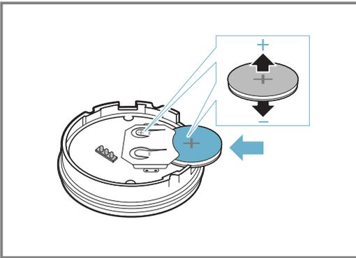
**Hinweis:** Keine Gegenstände aus Metall verwenden, um die Batterie zu entfernen. Die Batterieanschlusspunkte nicht berühren.
