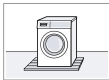
Collocare l'apparecchio su una base di legno resi stante all'acqua (spessore minimo di 30 mm) ben fissata al pavimento.
