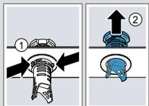
5. Unter fließendem Wasser die Siebelemente reinigen.
