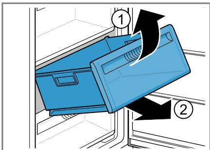
2. Die Klemme auf der linken Behälterseite durch Zusammendrücken lösen ① und den Eiszapfhahn entnehmen ②.
