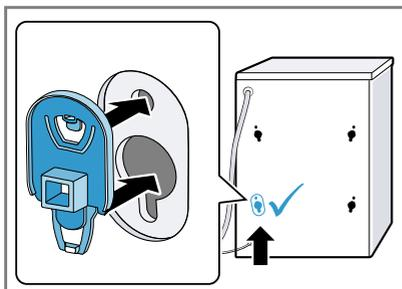
**Remarque :** Pour installer les cales de transport dans l'appareil pour le transport, exécutez ces étapes dans l'ordre inverse.
