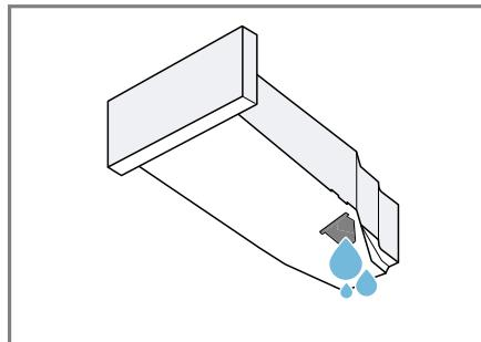
Регулярно проверяйте фильтр резервуара для конденсата
