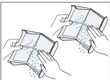
8. Тщательно промойте обе фильтрующие сетки под теплой проточной водой и высушите их.
