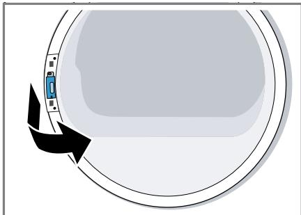
3. Установите дверной замок с противоположной стороны.
