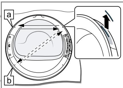
Выберите положение индикатора дверной ручки в зависимости от места установки прибора:
