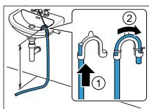
Полностью пропустите сливной шланг через изогнутий держатель → Страница 13 и закрепите с помощью крепежного материала.
