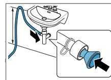
Зафиксируйте соединение хомутом (12–22 мм).
