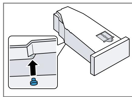
3. Očistite filter v posodi za kondenzat.
