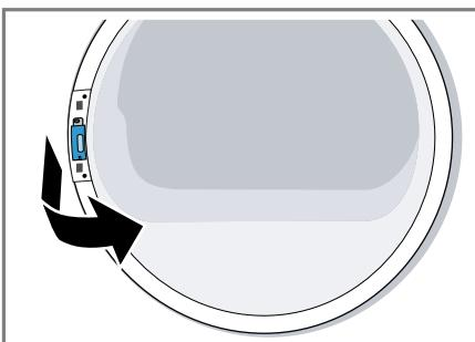
3. Mehanizem za zaklepanje vrat vstavite na nasprotni strani.
