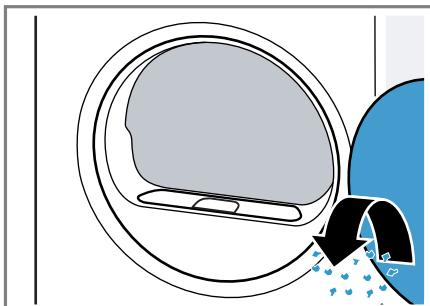
3. Odstranite dvodelni filter za vlakna.
