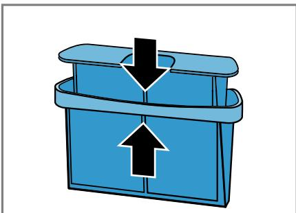
10. Vstavite dvodelni filter za vlakna.
