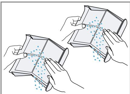
8. Oba filtra za vlakna temeljito očistite pod tekočo toplo vodo in ju osušite.
