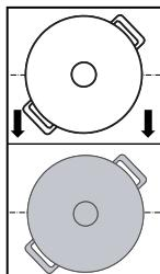
El recipiente es detectado y en el indicador de la nueva zona de cocción parpadean alternativamente el nivel de potencia y  $\text{L}$ .
