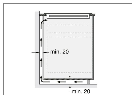
2. Una abertura en la parte superior de la pared trasera del mueble.
