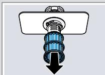
4. Apăsați butoanele de blocare ① apropiindu-le unul de celălalt și ridicați sita grosieră prin partea de sus ②.
