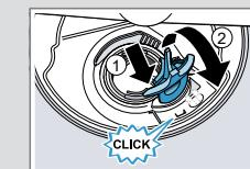
8. Montați sistemul de filtre.
