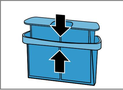
10. Das zweiteilige Flusensieb einsetzen.
