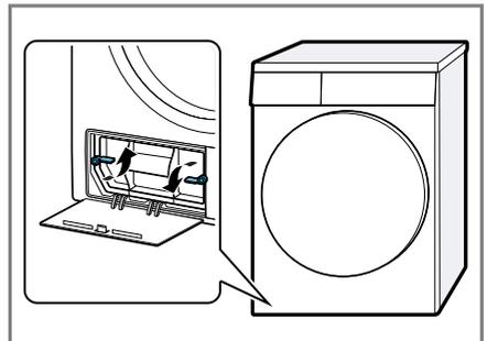
3. Die Wärmetauscherabdeckung am Griff herausziehen.
