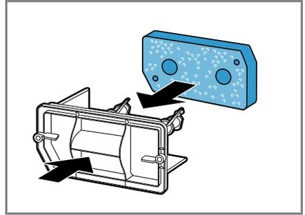
Stellen Sie sicher, die gereinigte Filtermatte nicht zu verformen, zu beschädigen oder seitenverkehrt auf die Halterungen zu schieben.
