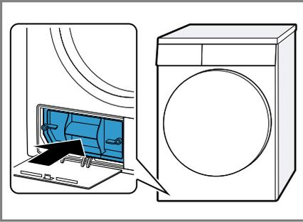
2. Die Hebel der Wärmetauscherabdeckung schließen.
