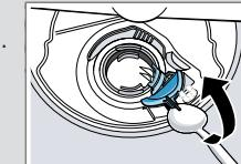
4. Die Pumpenabdeckung mit Hilfe eines Löffels ausheben und am Steg fassen.
