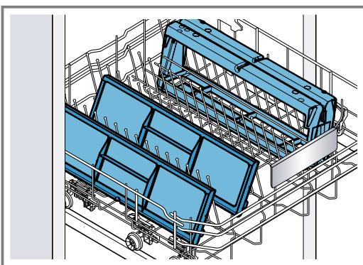
Stark verschmutzte Fettfilter nicht mit Geschirr reinigen.
