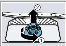
2. Ruotare il filtro grosso in senso antiorario ① e togliere il sistema di filtraggio ②.
