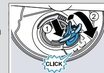
8. Montare il sistema di filtraggio.
