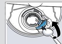
4. Die Pumpenabdeckung mit Hilfe eines Löffels aushebeln und am Steg fassen.
