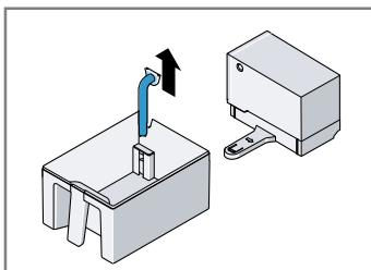
3. Setzen Sie den Ansaugschlauch mit Anschlussstück um 180° gedreht in die Öffnung der Pumpenabdeckung ein.
