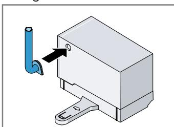
4. Füllen Sie vorsichtig ca. 15 ml Trinkwasser in den Ansaugschlauch mit Anschlussstück.
