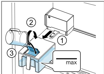
2. Den Deckel schließen und den Wassertank wieder einsetzen.
