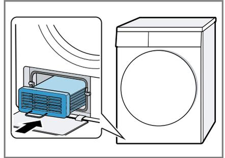
Asegurarse de insertar el intercambiador de calor con el asa hacia abajo.
