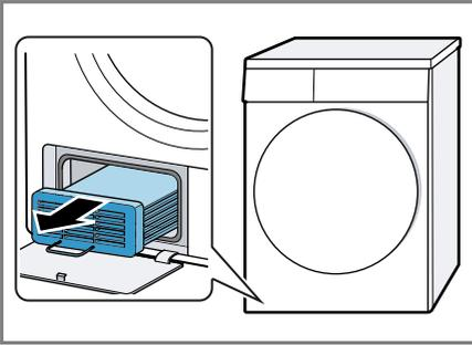
4. Lavar el intercambiador de calor por todos los lados con agua corriente y secarlo.
