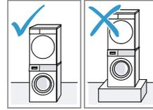
Instalar este aparato encima de una lavadora solo con el kit de conexión original del fabricante de la secadora.
