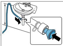
Asegurar el punto de conexión con una abrazadera (12-22 mm). Fijar la manguera de salida de agua con un tubo guía de una
