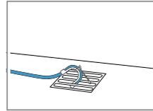
Deslizar la manguera de salida de agua completamente por el y fijarla con el material de fijación. Fijar el racor en codo en el canal.
