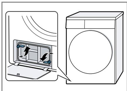
3. Tirar de la cubierta del intercambiador térmico por el asa.
