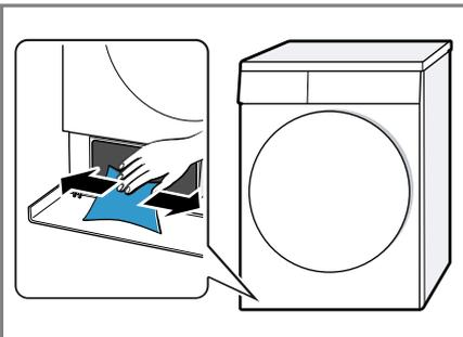
6. Introducir el intercambiador de calor en posición horizontal hasta el tope.
