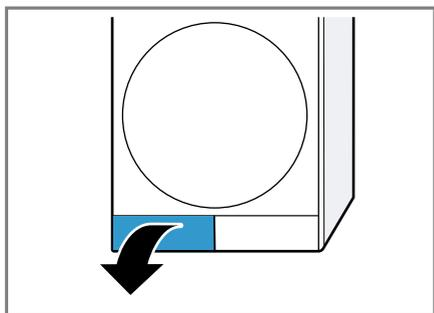
Si se coloca un paño debajo de la trampilla de mantenimiento, se puede recoger el agua residual de la unidad de la base.
