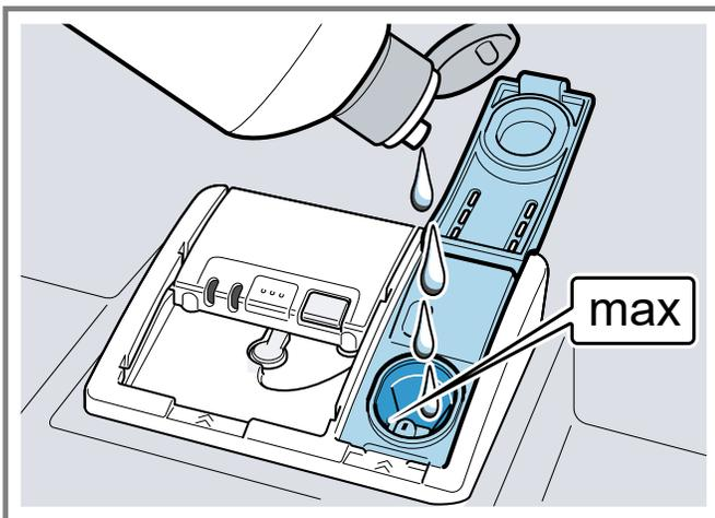
3. Si le réservoir déborde, retirez l'excédent de la cuve. Le liquide de rinçage excédentaire peut entraîner la formation excessive de mousse lors du rinçage.
