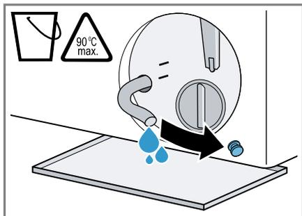
8. Appuyez sur le bouchon de fermeture.
