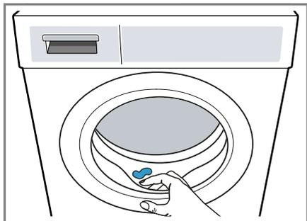
4. Laissez la porte de l'appareil et le bac à produits ouverts afin que l'eau résiduelle puisse s'évaporer.
