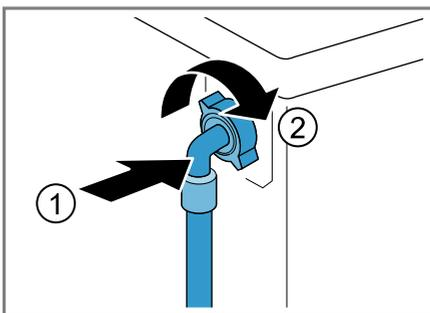
2. Raccordez le tuyau d'arrivée d'eau au robinet d'eau (26,4 mm = 3/4").
