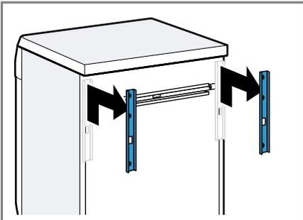
3. Die Schrauben der horizontalen Transportstrebe mit einem Schraubendreher T20 lösen und entfernen.
