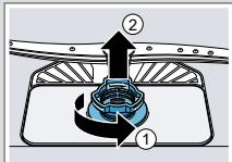
2. Γυρίστε το φίλτρο για χοντρή ρύπανση ενάντια στη φορά των δεικτών του ρολογιού ① και αφαιρέστε το σύστημα φίλτρων ②.
