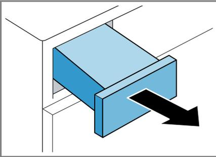
2. Vider le réservoir d'eau de condensation.
