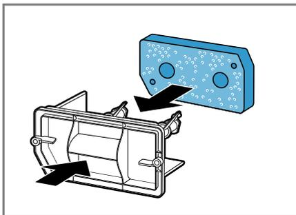
Veillez à ne pas déformer, endommager ni faire glisser latéralement le matelas filtrant nettoyé sur les supports.
