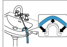
Fissare e assicurare il raccordo di scarico dell'acqua con un collettore → *Pagina 28*.
